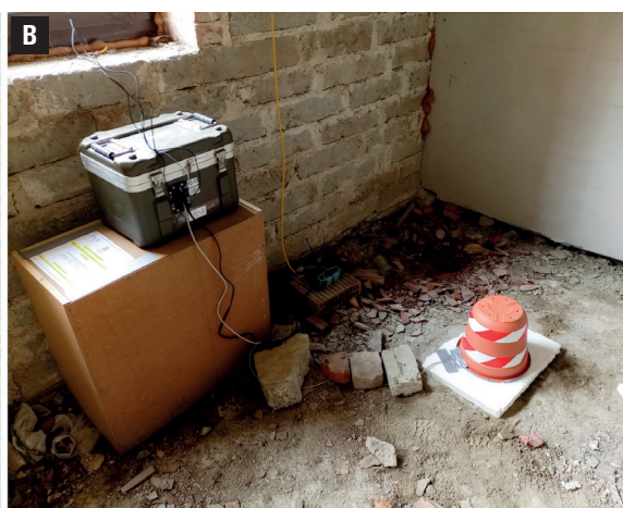
Lokalizacja i konfiguracja stacji sejsmicznych: A) Lokalizacja stacji. B) Stacja w miejscu po rozmieszczeniu. C) Części stacji, takie jak digitizer i router. D) Czujnik
