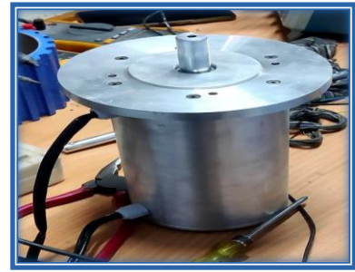
Fig. 5. Actual 48V, 1.5 kW BLDC motor developed
