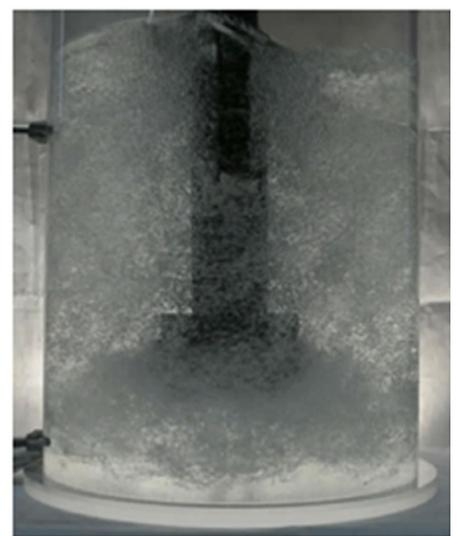
i) Variant I: 650 rpm and 15.0 Nl·min<sup>-1</sup>
