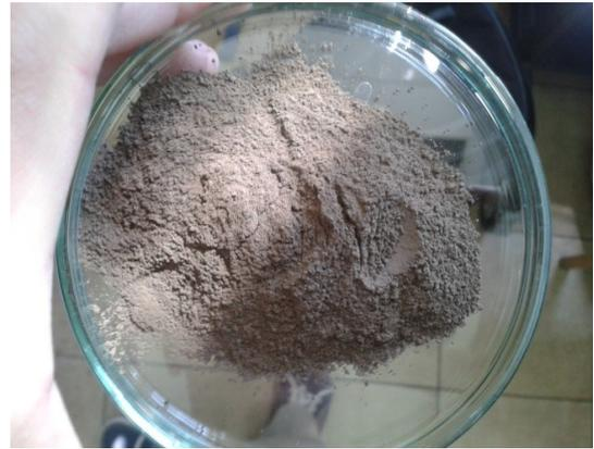
Fig. 4. Powdered flash slag
