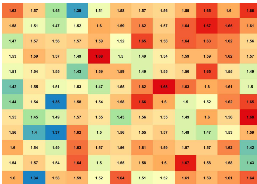
Rys. 3. Rozkład wymiaru fraktalnego dla płytki cienkiej piaskowca
