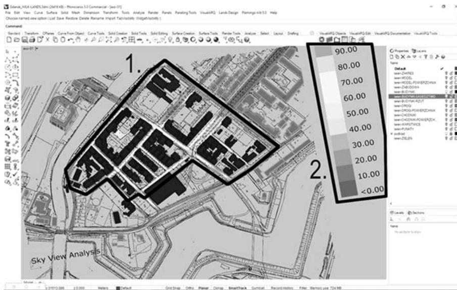
Ryc. 2. Analiza pola widoczności w zabudowie ulicy. Środowisko programu Rhinoceros. Legenda: 1 – analizowany obszar, 2 – legenda Źródło: Opracowanie własne (ryc. 2-9).
