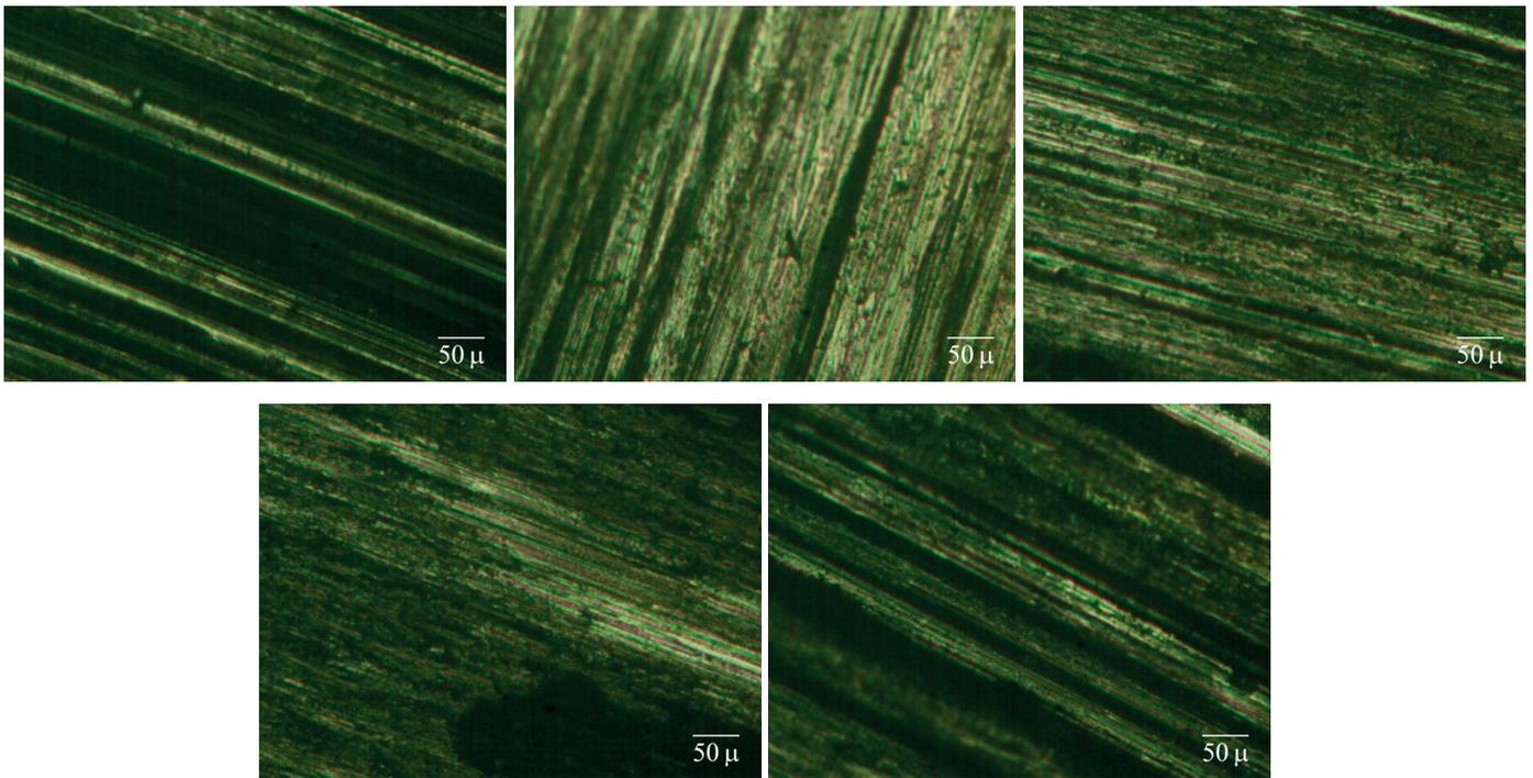
Fig. 7. Optical micrograph of worn surfaces: a) Al-12Si-2B<sub>4</sub>C, b) Al-12Si- 4B<sub>4</sub>C, c) Al-12Si-6B<sub>4</sub>C, d) Al-12Si-8B<sub>4</sub>C, e) Al-12Si-10B<sub>4</sub>C
