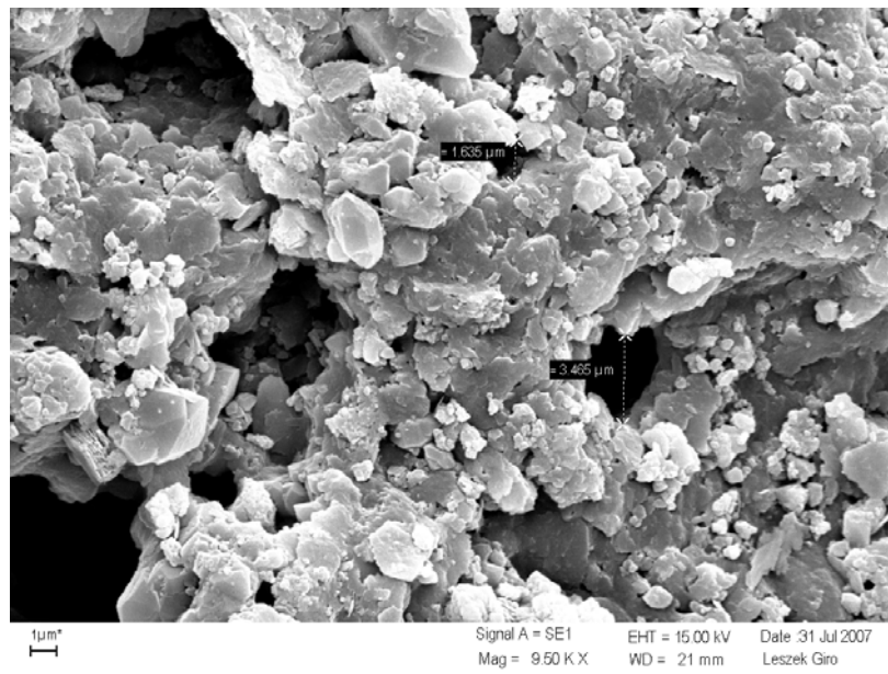
Rys. 5. Mikrofotografia SEM powierzchni chalcedonitu (powiększenie \times 9500 )
