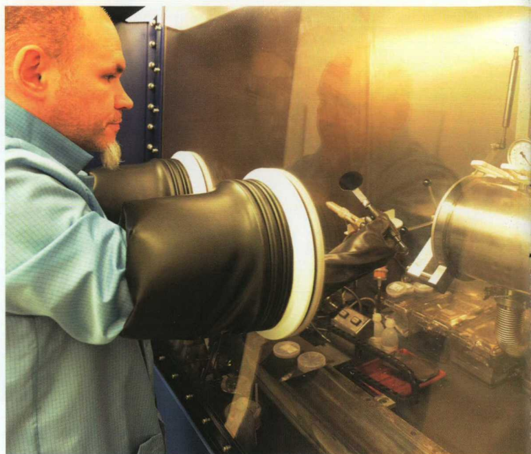
System AIX-200 firmy AIXTRON do wzrostu warstw epitaksjalnych HgCdTe ze związków metaloorganicznych. Na dole: detektory podczerwieni
