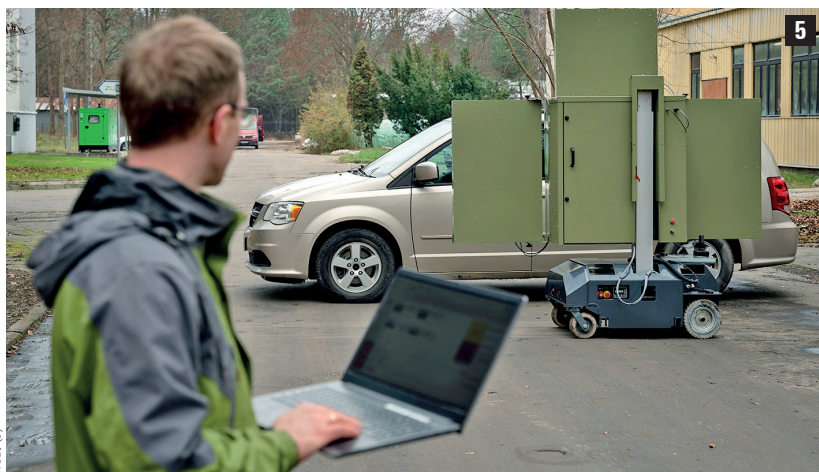
Fot. 5 Mobilne urządzenie ISWOT, wykorzystujące fotony rozpraszane wstecznie, pozwala na wykrywanie osób ukrytych w pojazdach ciężarowych
