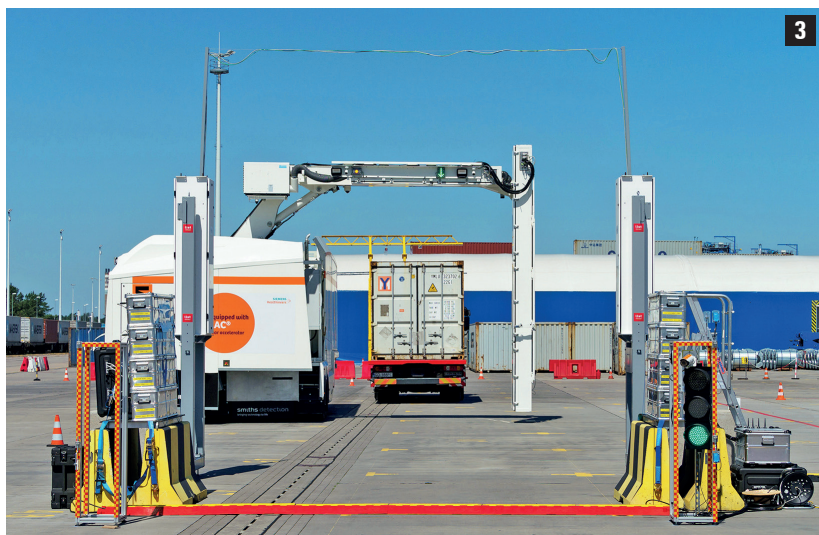
Fot. 4 System CANIS prześwietla wagony kolejowe wjeżdżające na teren Unii Europejskiej
