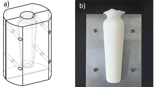
Fig. 2. a) metal mold; b) stearin casting
