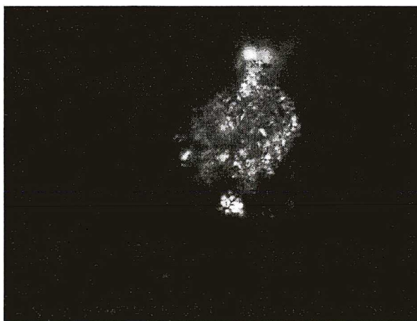
Fot. 1. Kryptokrystaliczne agregaty z pręcikami mullitu. Światło przech., NX, pow. 400×, próbka P-2
