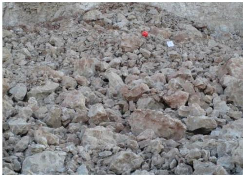
(d) Fragmentation of 20% bottom air deck blast at Bench-1
