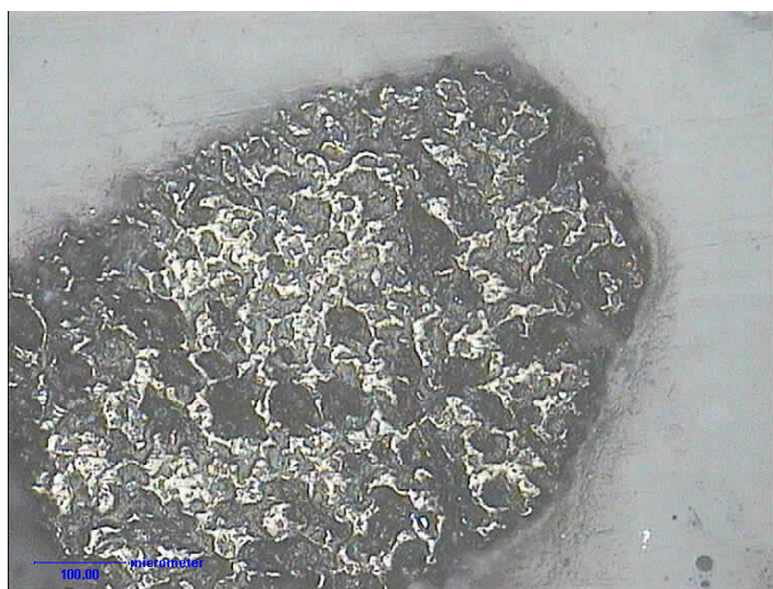
Fot. 2. Niespalona materia organiczna w formie sieci, klasa ziarnowa powyżej 0,315 mm. Światło odbite, pow. 100×
