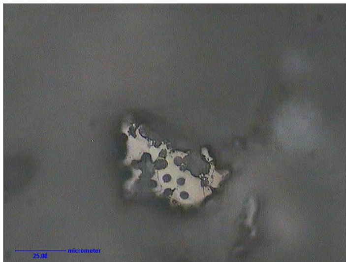
Fot. 5. Niespalona materia organiczna w formie inertynitu, klasa ziarnowa 0,09–0,071 mm. Światło odbite, pow. 500×
