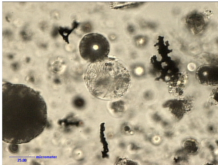
Fot. 7. Igiełkowe kryształy mullitu w formie inkluzji sferycznych cząstek popiołu. Pola czarne – niespalona materia organiczna w formie detrytusu, próbka popiołu surowego. Światło przechodzące, pow. 400×
