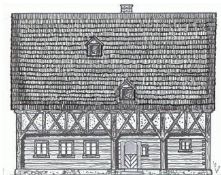
Ryc. 4. Nieistniejący budynek z konstrukcją przysłupową i ścianką kolankową w Strudze. Elewacja wejściowa. Rys. autora, kopia według [Franke 1936]
